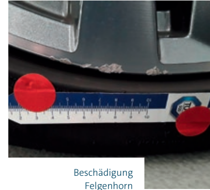
Beschädigung Felge mit Materialabtragung
